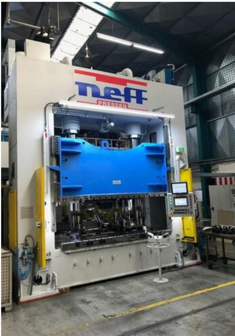
**DZP 800 t mit 4-Punkt Schnittschlagdämpfung und Stößel-Schrägstellungsüberwachung zur Herstellung von Automotive-Teilen**
