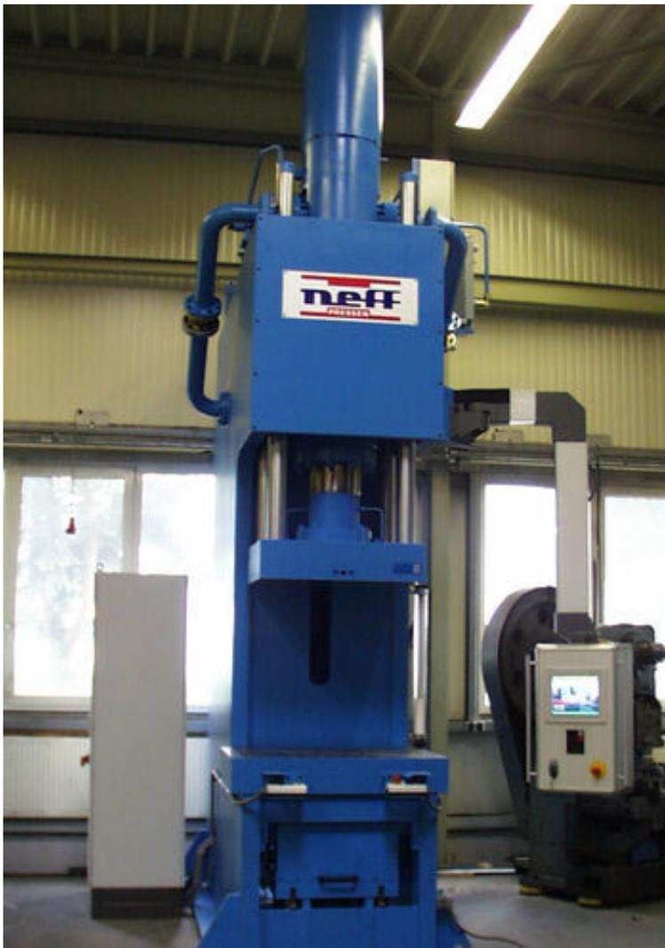
**EZP 160: Einständer-Tiefziehpresse 160 to. mit 4-fach geführter Stößelplatte und Werkzeug-Spannsystem**
