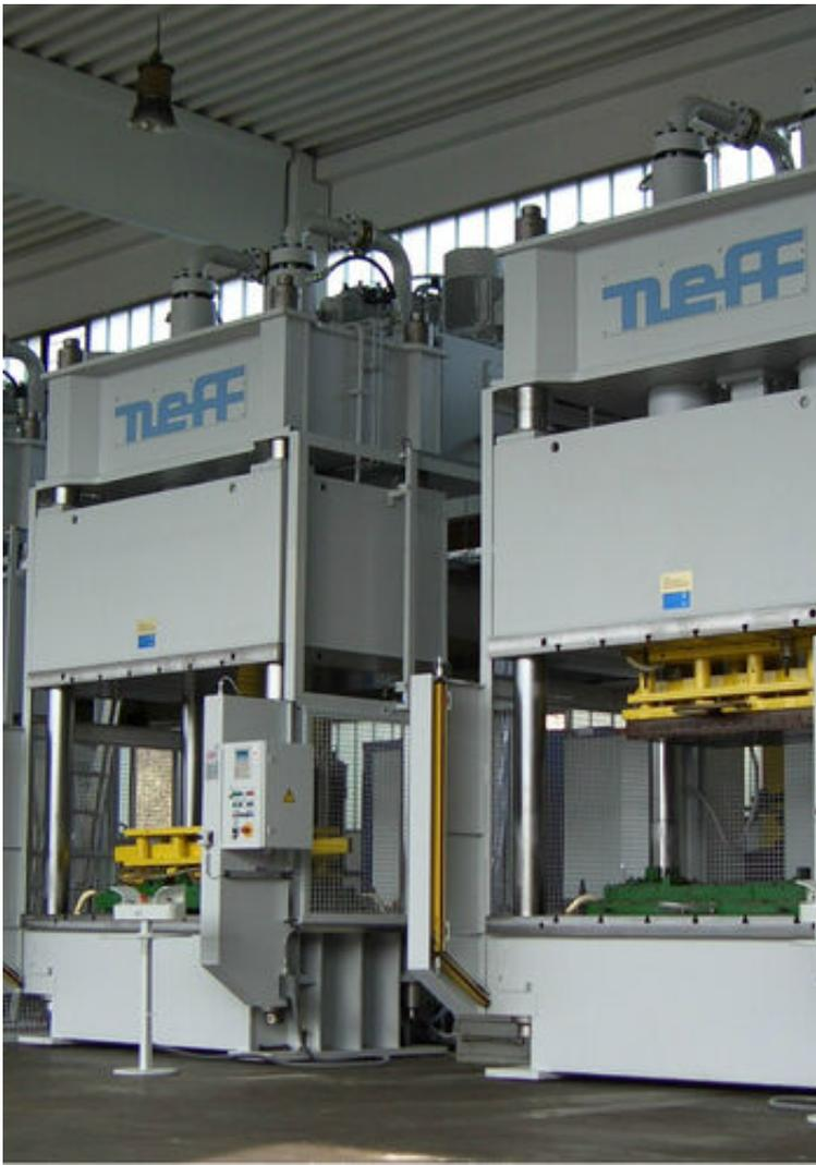
**4SP 160: 4-Säulen-Pressen 160 t und 400 t Druckleistung zur Herstellung von Automotive-Teilen**
