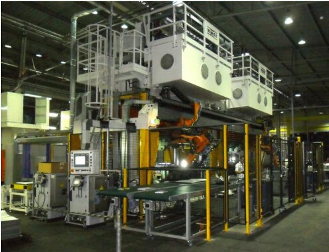
Die Anlage kann automatisiert im Einzelpressenbetrieb mit bis zu 3 Werkzeugstufen gefahren werden. Wenn bis zu 6 Umformstufen für die Teilefertigung benötigt werden, werden beide hydraulischen Pressen im verketteten Betrieb automatisiert betrieben.
